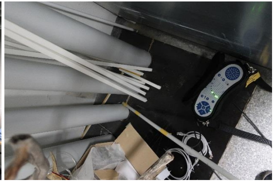
Kuvat 28 ja 29, tilassa B123 (LVI) vasemmassa nurkassa useita putkiläpivientejä, joilta havaittiin tulevan laaja-alaisesti kohtalaista vuotoa, mistä johtuen koko tilassa oli runsaasti kaasua mittausketkellä. Putkiläpiviennit ovat yhteydessä kellaritiloihin
