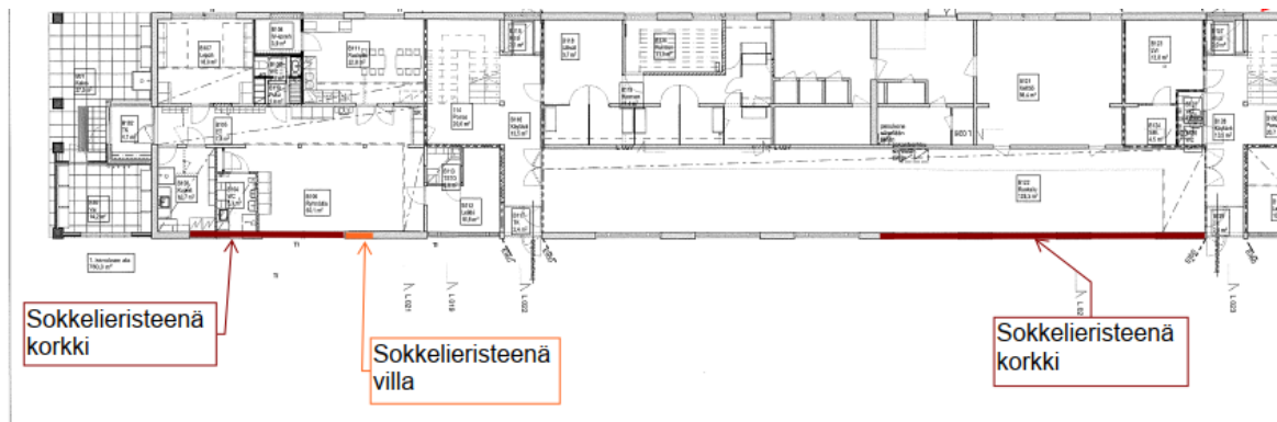
Kuva 29, alueet, joissa todettiin korkkieriste.
