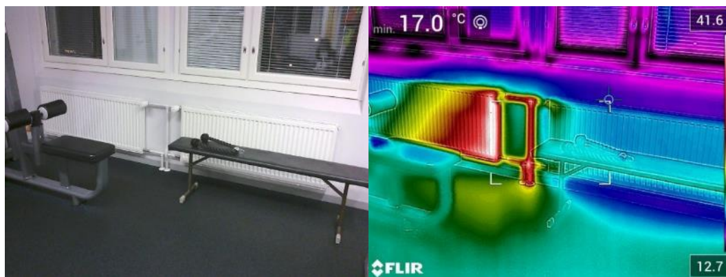
Kuva 79. B342 ikkunoissa ilmapuotoa. Patterit eivät toimi suunnitellusti. Ulkolämpötila -10,5
