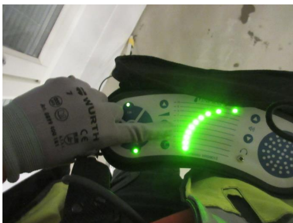
Kuva 106, ruokala. Kattavasti runsasta sekä kohtalaista vuotoa ulkoseinällä.
