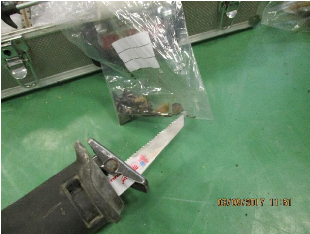
Kuva22. RA2 Bitumisively materiaalinäyte. Ei sisältänyt asbestia tai PAH-yhdisteitä. Analyysivaustaukset Liite 5 ja Liite 6.
