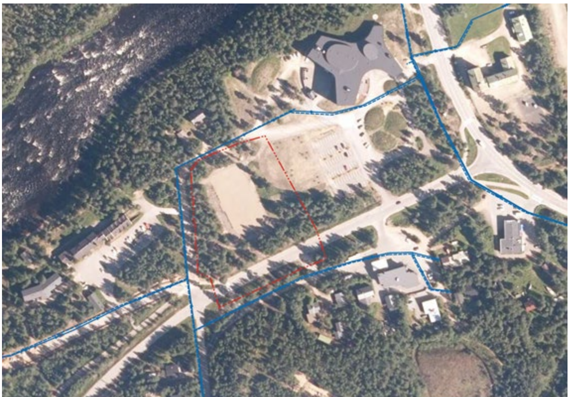
Kuva 4 Kunnallistekninen verkosto Maanmittauslaitoksen ilmakuvalla
