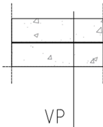
Kuva 38. Periaatepiirros, asuntola 2, 2. kerroksen välipohja RA29 (tila 23, WC)
