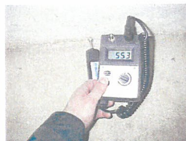
Pintabetonilaatasta ei havaittu kohonneita kosteuksia säilytystilojen alueella.
